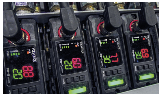
Equipamiento opcional: medición del caudal por ultrasonido sin mantenimiento
